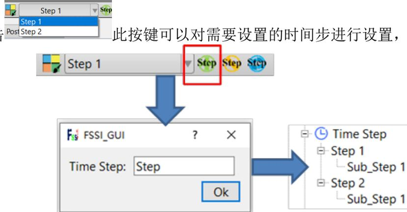
图 1-18 增加时间步的步骤示意图
